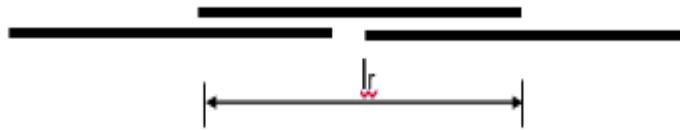
Figure. III.11 : Recouvrement par couvre-joint ( $l_r = 2 l_s$ )
