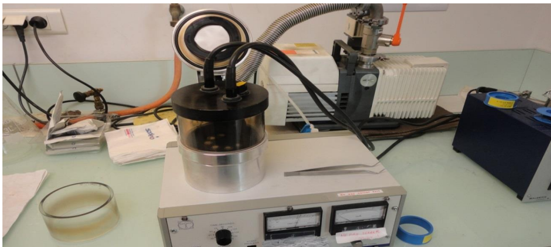
Figure.2: Photographie de l'étape de métallisation des argiles.
